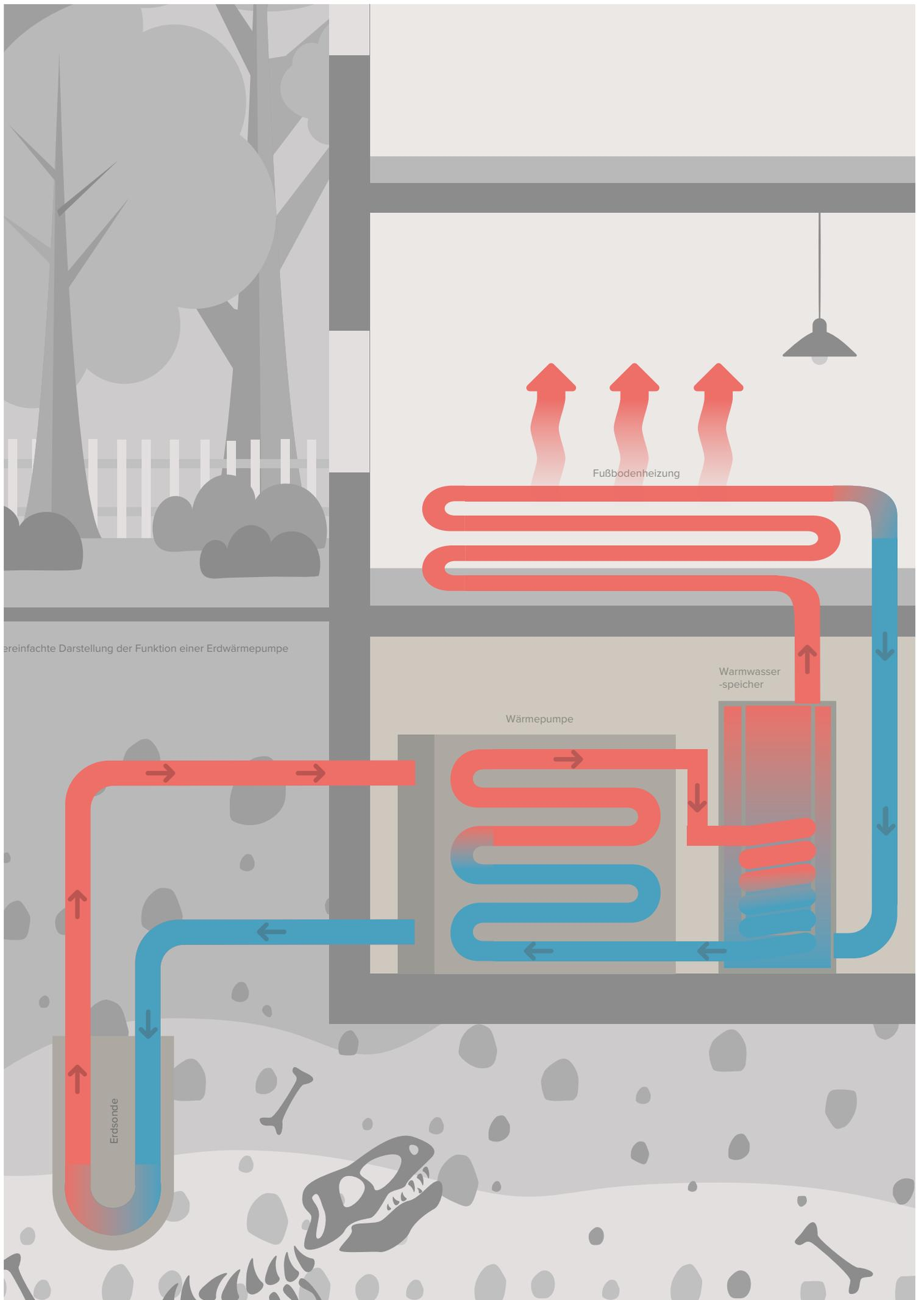
vereinfachte Darstellung der Funktion einer Erdwärmepumpe
